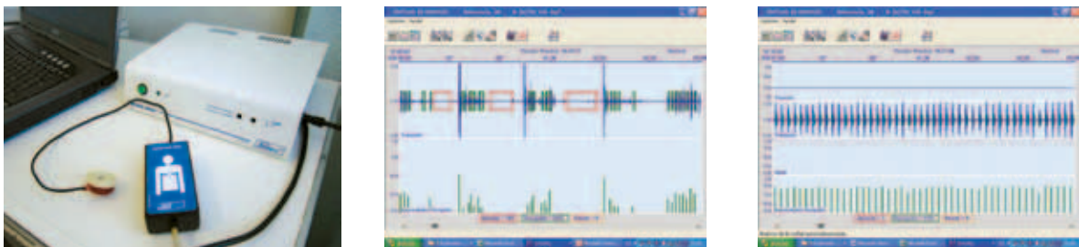
Detecció i interpretació dels sons de la respiració en un nou dispositiu portàtil monocanal per al cribatge basat en el ronc de la síndrome d'apnea obstructiva del son (SAOS).
