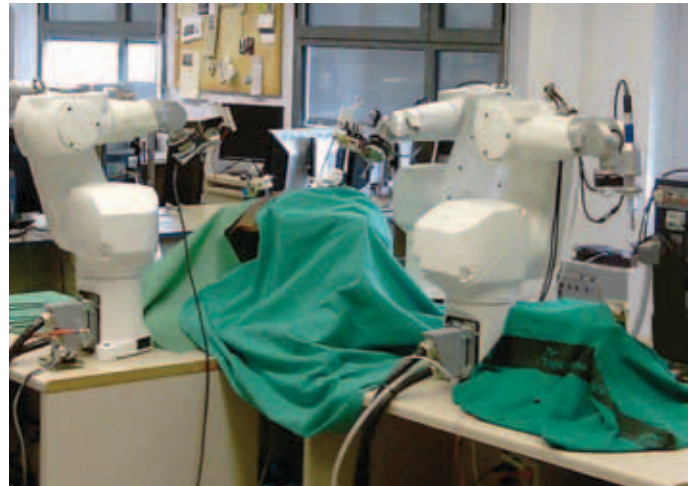
Plataforma quirúrgica robotitzada experimental per a cirurgia laparoscòpica (amb el CREB-UPC).
