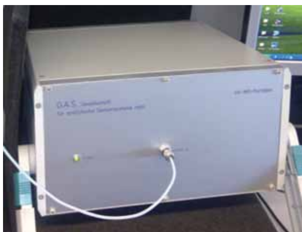
Espectròmetre ultraviolat-mobilitat iònica de GAS (Alemanya)
