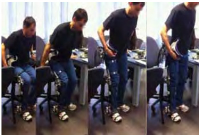
Seqüència d'un experiment de posar-se dret des de la posició asseguda amb l'assistència de la neuropròtesi i neurorobot HYPER.
