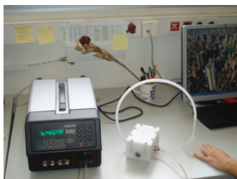
Experiments amb un respirador mecànic per investigar la influència de la dinàmica de la respiració en la resposta dels sistemes d'olfacte artificial.
