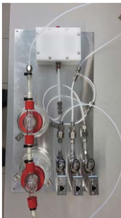
Sistema per provar sensors químics per a la detecció de mals olors
