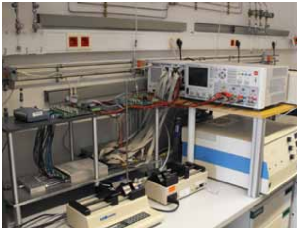
Sistema per provar la diversitat i la redundància de matrius de sensors químics
