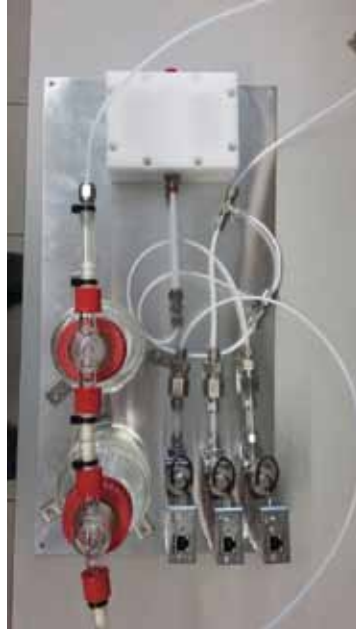
Sistema per provar sensors químics per a la detecció de males olors
