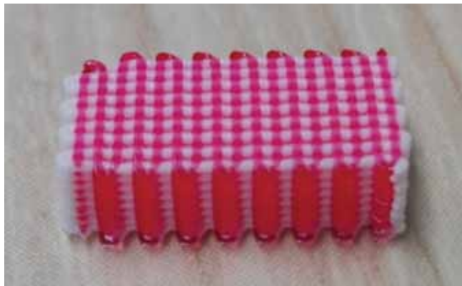
A sota: Construcció 3D amb multimaterial feta de dos tipus d'hidrogels generats amb la bioimpresora 3D de l'IBEC
