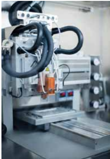
Esquerra: Detall de la bioimpresora 3D situada al BioSpace, que està equipat amb tres extrusores per a impressió amb multimaterial
