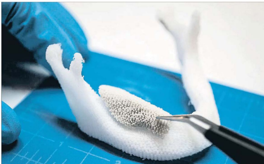
Este material poroso es el que se fabrica en la bioimpresora en 3D a la medida exacta del hueso que hay que suplir y que deberá integrarse
